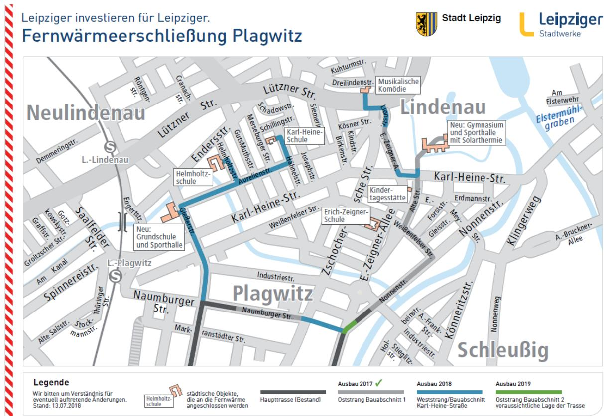
Abb. 01: Trassenerweiterung in drei Ausbaustufen von 2017 bis 2019 (Quelle: Netz Leipzig GmbH)
